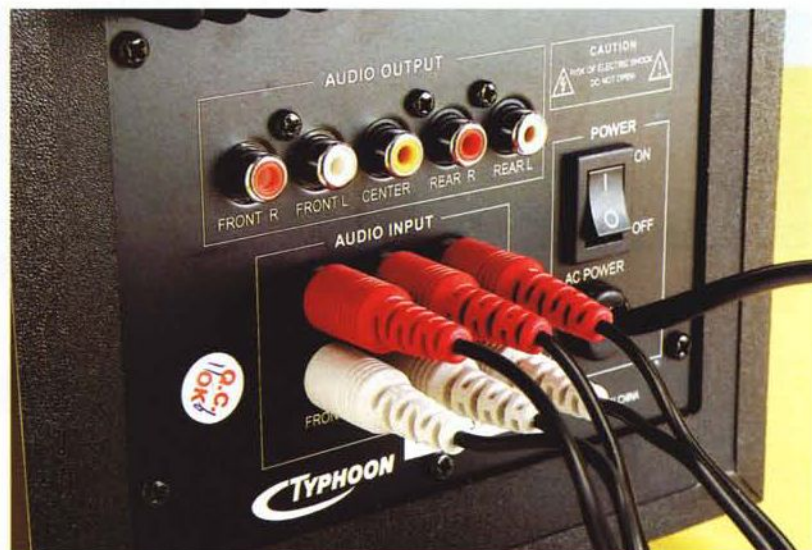
In un collegamento a 5+1 canali le sei uscite indipendenti (tre uscite stereofoniche) della scheda vengono collegate ai corrispondenti ingressi dell'amplificatore multicanale, in questo caso contenuto nel sub. Ogni canale ha un suo amplificatore ed il segnale non viene trattato, neanche quello del subwoofer, visto che è lo stesso segnale di ingresso dedicato al sub ad essere filtrato.
